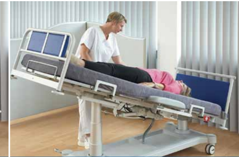
La position de déclive par pédales bilatérales est rapide et ergonomique car elle laisse les mains libres au personnel.
