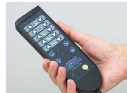
Les trois positions les plus importantes sont pré-programmées sur la télécommande. Des touches supplémentaires permettent le réglage individuel des positions.
